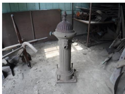
倉庫に保管されていた蛇体鉄柱式共用栓 吐出口は獅子(ライオン)
